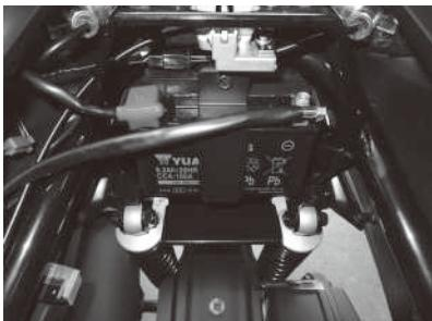
5. 電極接頭部位附著白色粉末時，用溫水來清理。有顯著腐蝕時，以鋼刷或砂紙磨掉。
