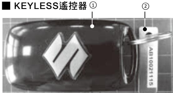
本車只配備一組 KEYLESS 遙控器 ① (如上圖)，不需鑰匙之電子主開關，請謹慎保管，如果遺失遙控器則無法打開 KEYLESS 主開關，請顧客務必謹慎保管遙控器及晶片密碼卡片 ②。
