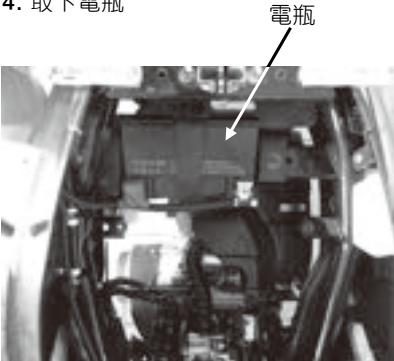
5. 電極接頭部位附著白色粉末時，用溫水來清理。有顯著腐蝕時，以鋼刷或砂紙磨掉。
